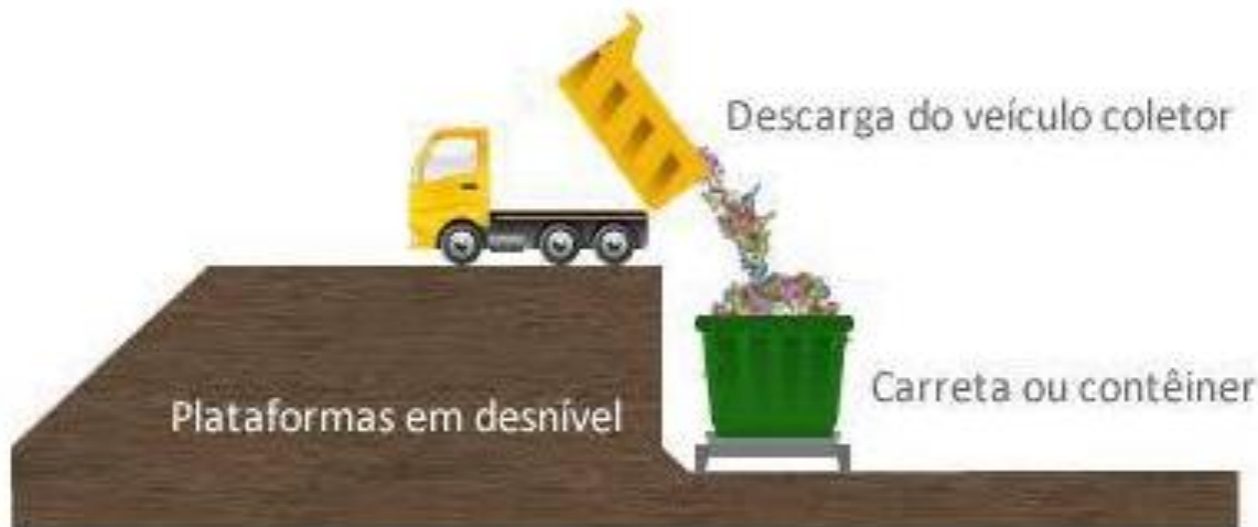
Figura 29 - Modelo de Estação de Transbordo Provisória.
